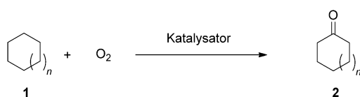
Schema 1. Reaktionstyp der Direktoxidation von Cycloalkanen zu Cycloalkanonen mit Sauerstoff.
